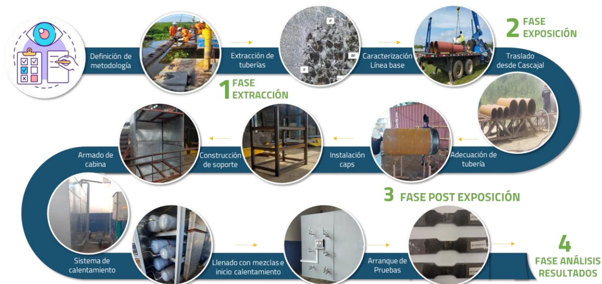
Figura 4 Metodología experimental diseñada y ejecutada por PROMIGAS en estudio de integridad de tuberías ante mezclas con hidrógeno. Fuente: Elaboración propia.
