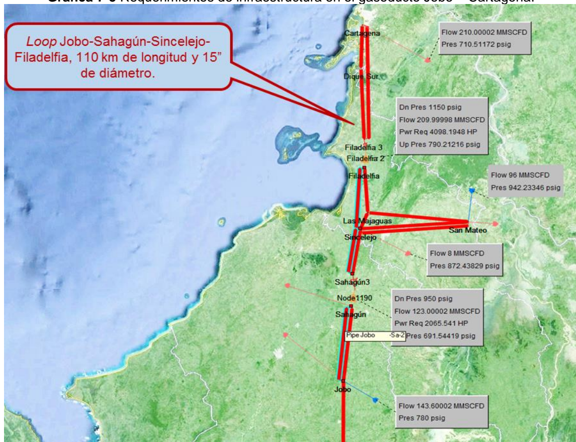
Gráfica 7-5 Requerimientos de infraestructura en el gasoducto Jobo – Cartagena.
