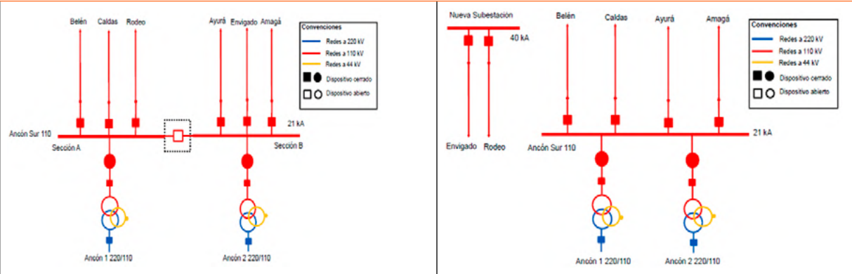
Diagramas unifilares de la obra propuesta.
