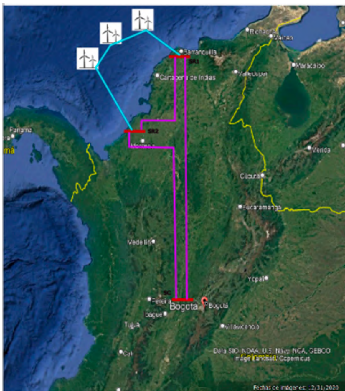
Figura 6-2 Esbozo propuesta red en anillo HVDC.
